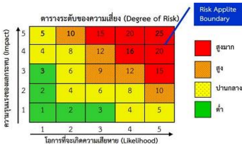
ตาราง Risk Matrix แสดงระดับความเสี่ยง (เป็นค่าคะแนนระหว่างโอกาส x ผลกระทบ)
